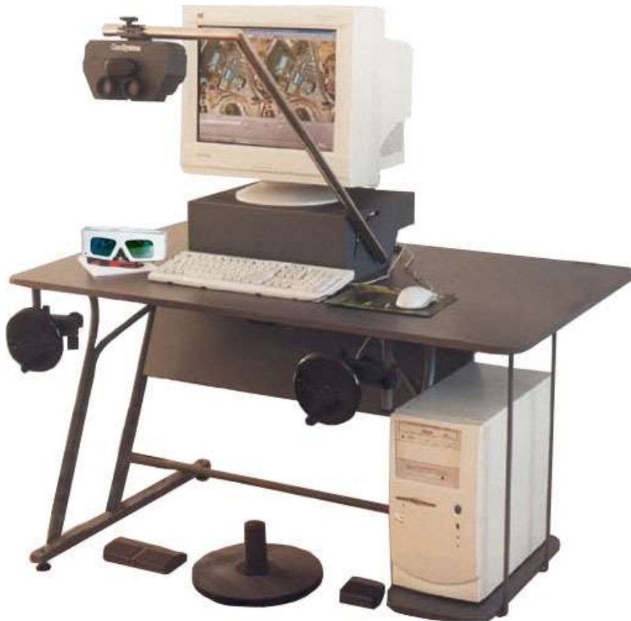
Digitale photogrammetrische Station mit Scanner und Stereobetrachtung durch Linsensystem (Stereoskop). Weitere Gerätebeispiele: Leica, Zeiss
