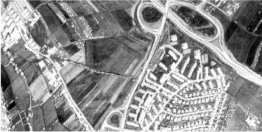
Roll-Verzerrungen bei turbulent gestörter Flugbahn eines Flugzeugscanners (aus Albertz, 1991)
