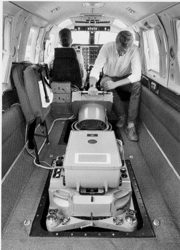
Zeiss Reihenmeßkammern RMK A 8,5/23 und RMK A 15/23 im Flugzeug eingebaut.
